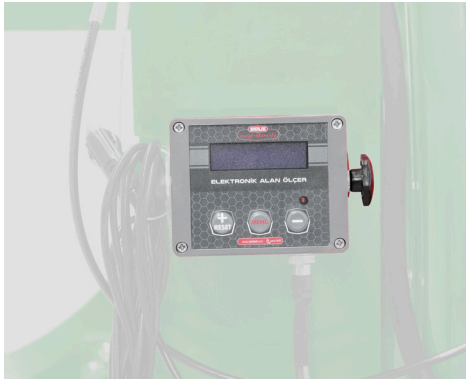
Ekilen araziye hassas olarak ölçebilen elektronik dekar sayacı.
